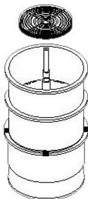
4) Вставьте собранную трубку для подачи воды в центральное отверстие дополнительного лотка, затем вставьте в лоток сетчатый диск.
