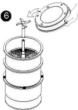
6) Установите на трубку для подачи воды разбрызгиватель. Закройте проращиватель верхней крышкой.
